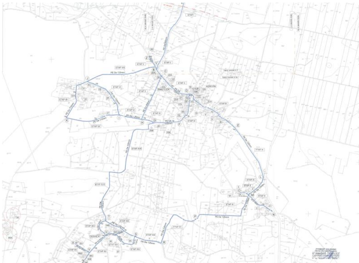
Rysunek 50 Koncepcja rozbudowy sieci wodociągowej w miejscowości Michałów
